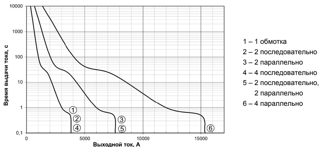
Рисунок 3.1 - Времятоковые характеристики трансформаторного блока
