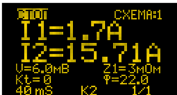
Рисунок 5.6 – Информационный индикатор. Режим «ТТ»
