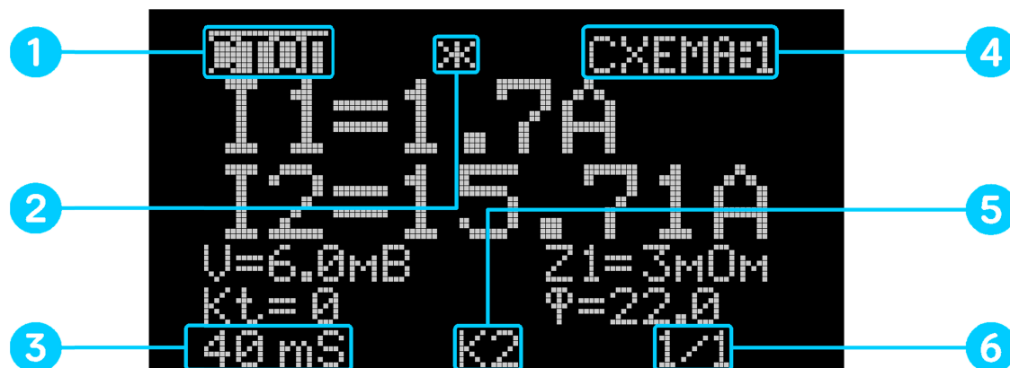
Рисунок 5.7 – Информационный индикатор. Отображение текущих настроек и состояния установки
