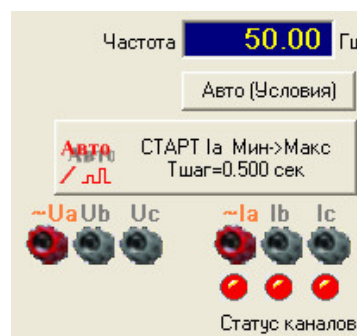
б) выдача токов в перегруз либо ХХ, индикаторы «Статус сигналов» с красным цветом
