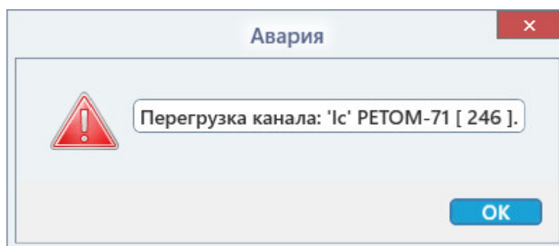
Рисунок 735. Перегрузка канала тока Ic.
