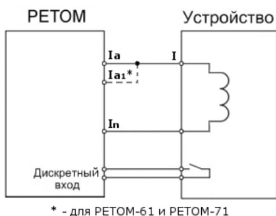
Рисунок 175. Схема по умолчанию для типа «Простое реле».
