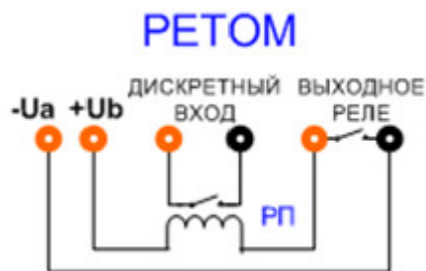
Рисунок 567. Схема для проверки промежуточного реле постоянного тока
