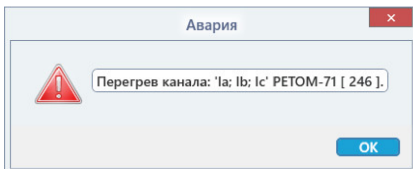
Рисунок 737. Перегрев каналов тока Ia, Ib, Ic.
