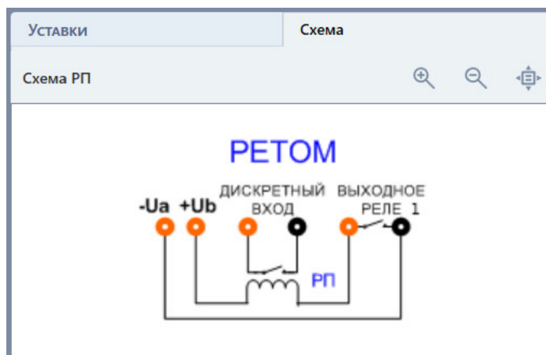
Рисунок 256. Схема подключения для проверки РП.
