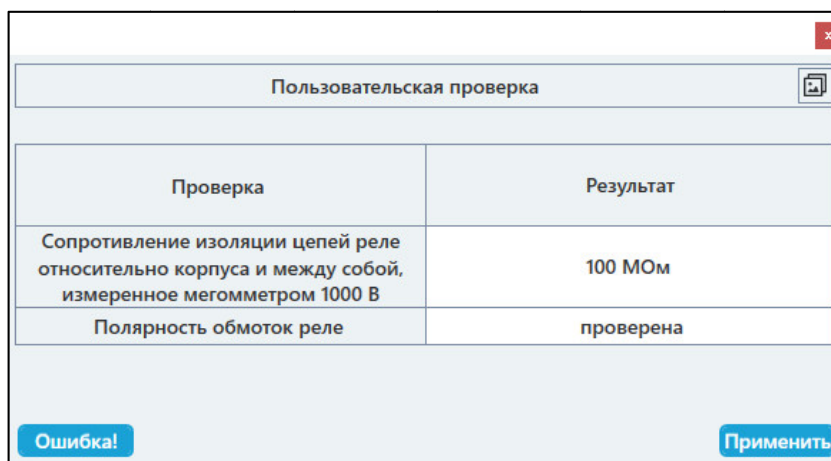
Рисунок 432. Таблица пользовательской проверки во время испытаний.
