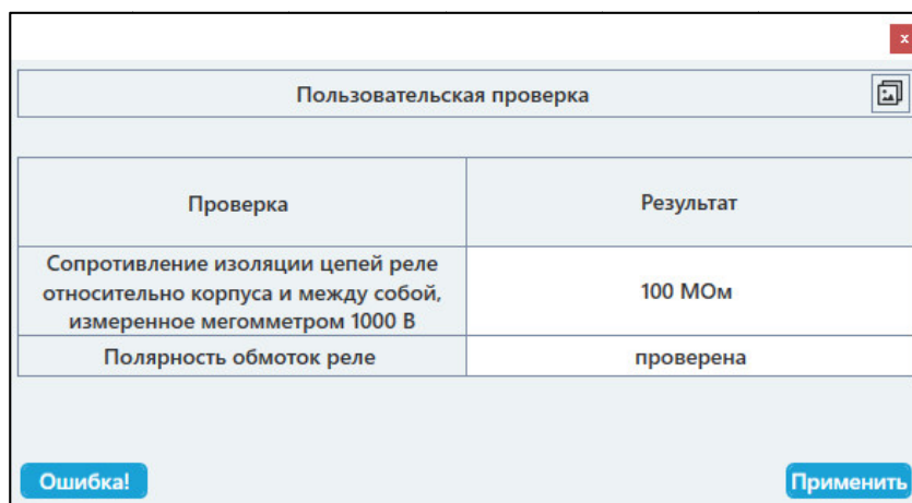
Рисунок 367. Таблица пользовательской проверки во время испытаний.
