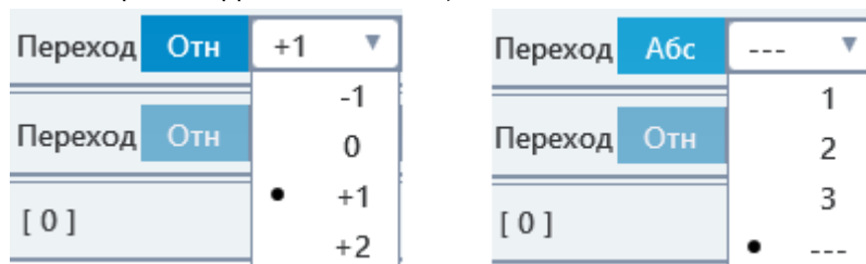
Рисунок 118. Относительный и абсолютный способы задания перехода.
