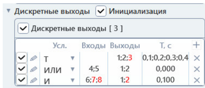
Рисунок 119. Настройка дискретных выходов.
