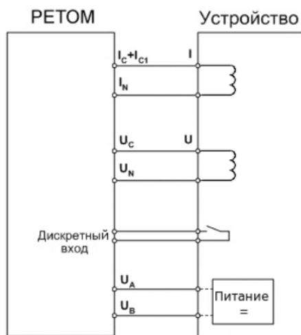
Рисунок 354. Схема по умолчанию для типа «Простое микроэлектронное реле».
