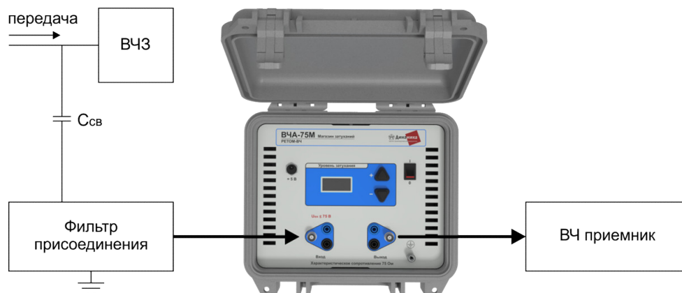
Рисунок 7.3 - Определение запаса по затуханию действующего канала, когда магазин затуханий стоит на приемной стороне
