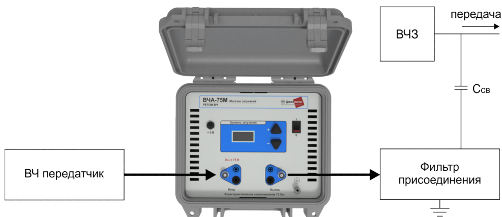
Рисунок 7.4 - Определение запаса по затуханию действующего канала, когда магазин затуханий стоит на передающей стороне
