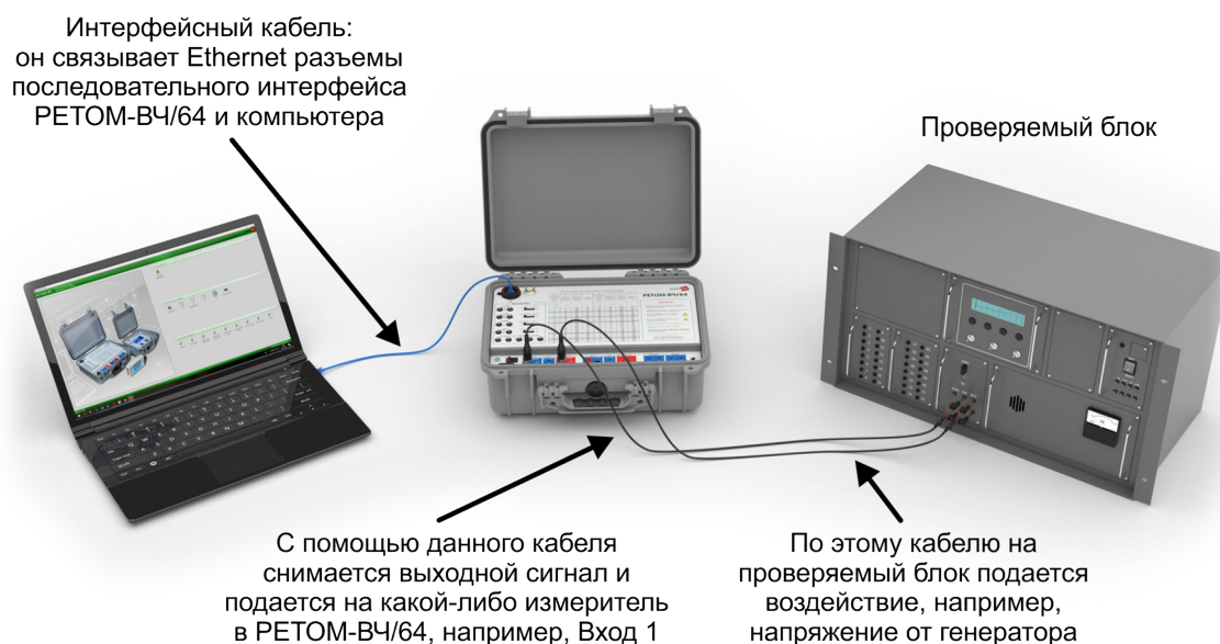
Рисунок 5.3 – Общая схема подключения устройства РЕТОМ-ВЧ/64 (сетевые шнуры не показаны)
