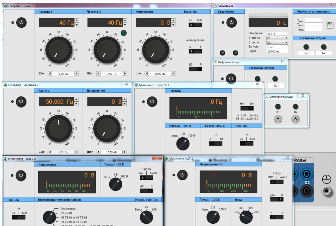
Рисунок 1.3 - Окно программы ВЧ лаборатория с извлеченными виртуальными приборами
